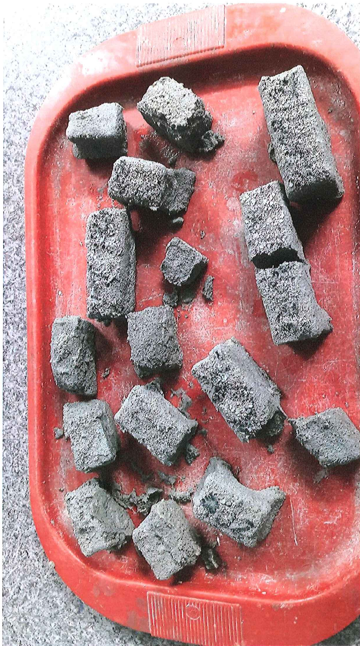
Załącznik nr 1 do sprawozdania nr SB/492/16 – widok próbek po 25 cyklach zamrażania/rozmarzania.
