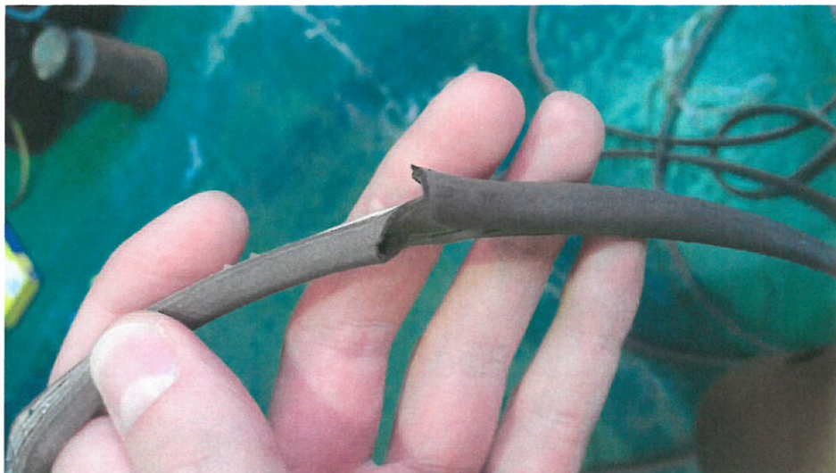
Fot. 1-3. Zdemontowana uszczelka (przez Przedstawicieli Producenta).
