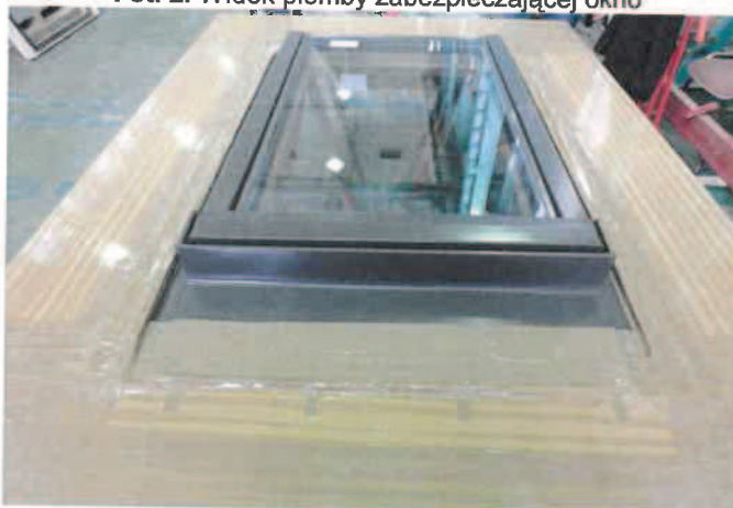
Fot. 3. Widok okna osadzonego w płycie symulującej połac dachową
